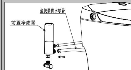
6. 将智能坐便器供水软管连接到前置净滤器(过滤水出水口)并将卡簧扣入即可
