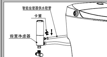
7. 将前置净滤器(自来水进水口)安装到供水角阀，然后用扳手或活口扳手加固拧紧。
