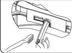
在开机离座状态，按下遥控器上的喷嘴清洗按键，清洗器自动伸出。如果喷嘴有污垢，可一手轻轻托住清洗器，一手用牙刷进行清洁。
