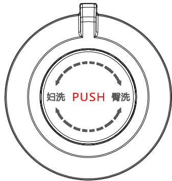
1. 着座后顺时针旋转调节旋钮时,开始智能臀洗功能,依次启动臀洗;逆时针旋转调节旋钮则开始智能妇洗功能。
