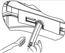
在开机离座状态，按下遥控器上的喷口清洗按键，清洗器自动伸出。如果喷孔有污垢，可一手轻轻托住清洗器，一手用牙刷进行清洁。
