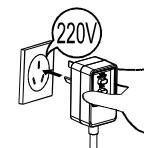
请定期将电源插头拔下，用干布擦拭电源插头上的灰尘。
