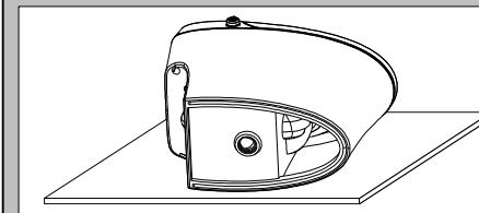
2. 目测, 在陶瓷排污口中心点所对应的陶瓷侧面上画一条垂直陶瓷底平面的线, 另一侧同上, 同时在陶瓷前部中间点画一条垂直地面的线。
