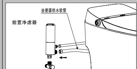
6. 将智能坐便器供水软管连接到前置净滤器(过滤水出水口) 并将卡簧扣入即可
