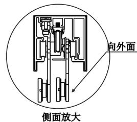
5. 安装上导轨组件，出厂时需将联动臂及上滑轮放入上导轨中包装出货，安装时只需对好朝外的一面，卡入已装好的边柱上即可，如图（5）。
